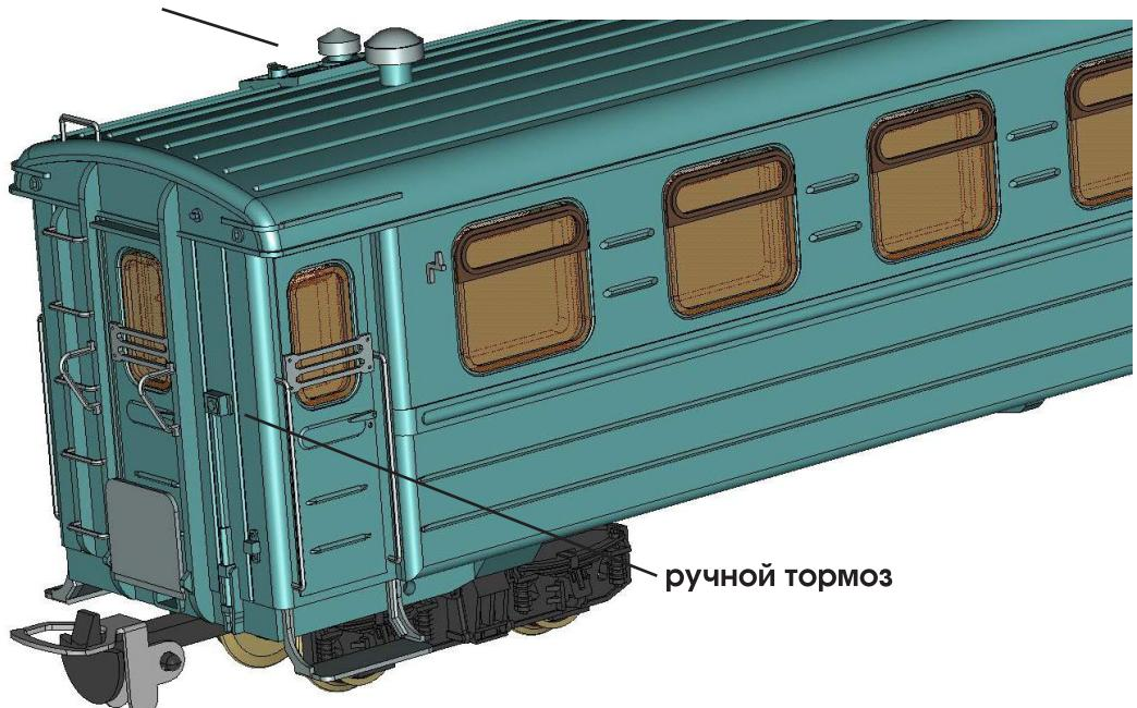
Деталировка торцевой стены
