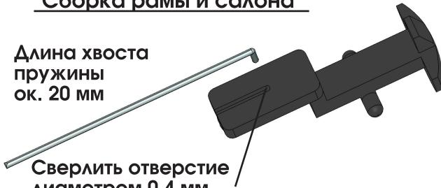
Сверлить отверстие диаметром 0,4 мм и надфилем пропилить канавку под возвратную пружину сцепки. Пружины вклейте или заварить паяльником.
